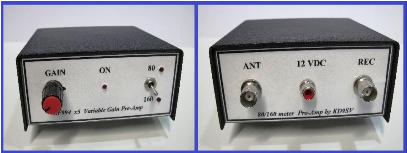
KD9SV ha progettato questo preamplificatore con lo specifico scopo di essere abbinato ad antenne riceventi di piccole dimensioni a limitato guadagno (come il Loop), per le bande 80/160 metri.
