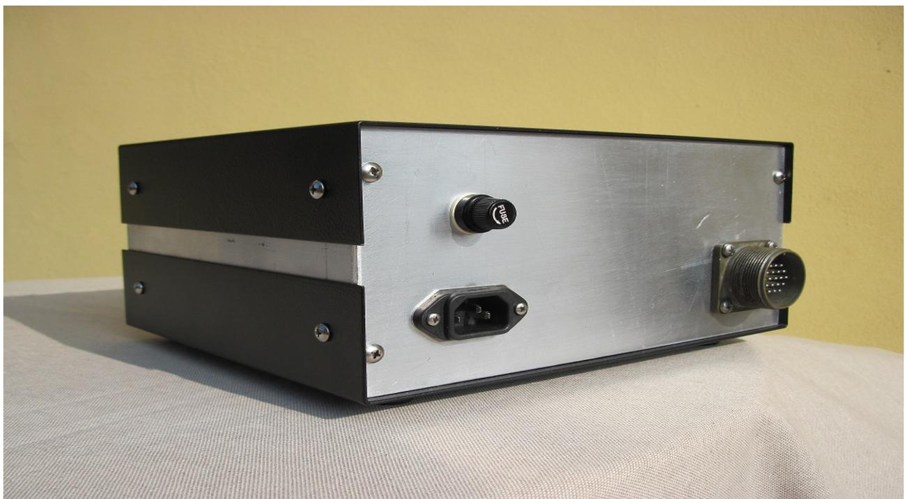
Sul pannello posteriore sono fissati il connettore multipolare per il cavo di connessione, la presa per i 230Vac completa di filtro di rete EMI/EMC ed un portafusibile con fusibile di protezione. Le misure perimetrali del contenitore utilizzato sono mm. 250x120x220.
