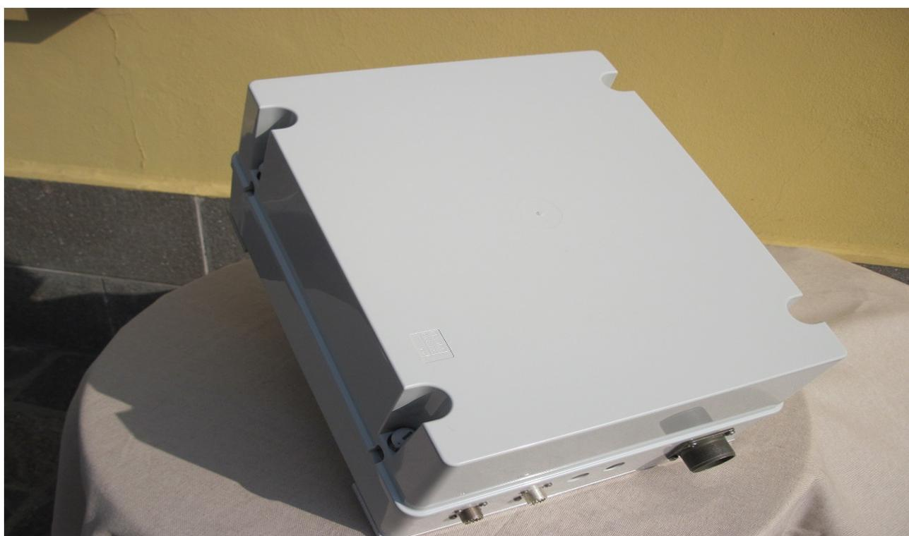
Ovviamente sul lato inferiore di questa cassetta dovranno essere fissati i due connettori SO239 per l'ingresso/uscita RF, il connettore multipolare per le connessioni al Controller e molto importante, prevedere un paio di fori protetti da microrete in acciaio inox (per evitare intrusione di insetti), con il compito di favorire la circolazione dell'aria all'interno del contenitore creando in pratica un effetto camino per evitare formazione di pericolose condense.
