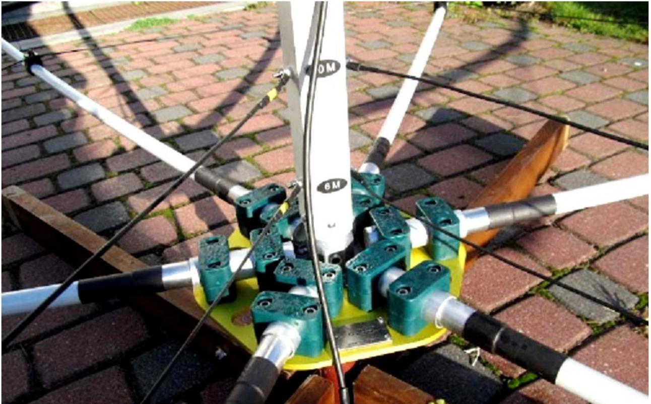
Particolare di montaggio Hexbeam 20-17-15-12-10-6 mt di SP7IDX
