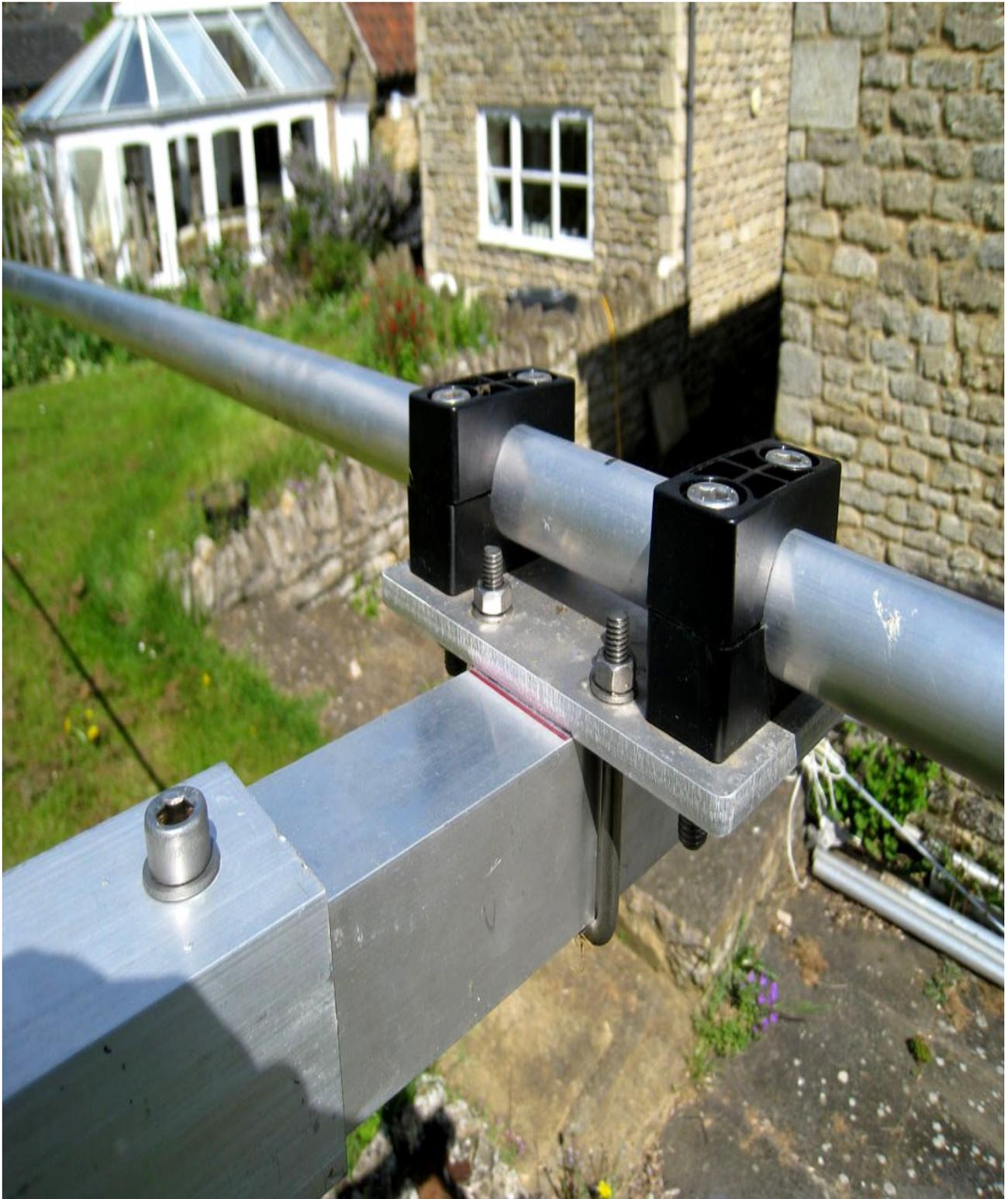
Soluzione bloccaggio elemento sul boom
