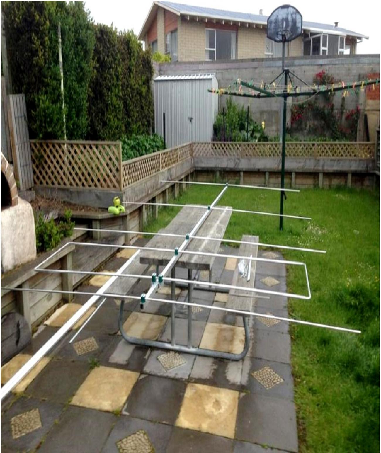
Yagi 5 elementi LFA 6 mt di G0KSC
