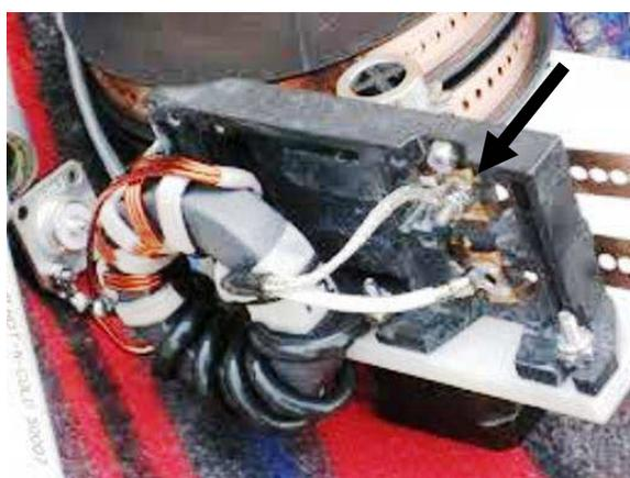
**14)** Pur non essendo la panacea alla soluzione del problema, consiglio di collegare in serie al cavo di alimentazione dei motori un semplice circuito di protezione facilmente realizzabile, che interrompe elettricamente tutti i collegamenti fra Controller e motori quando l'antenna non è in uso. Questo per cercare di prevenire danni ai circuiti elettronici del Controller durante temporali, statiche ecc.
