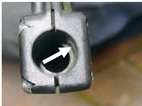
Consiglio comunque in ogni caso, eseguire nell'eventualità che gli O-RING perdano nel tempo la tenuta, anche un collare con vari strati sovrapposti di nastro autoagglomerante sul punto d'innesto delle canne nel componente in policarbonato (Fittings) che forma il raccordo fra canne e la curva del dipolo, creando così un'ulteriore protezione alle infiltrazioni d'acqua verso le curve.
