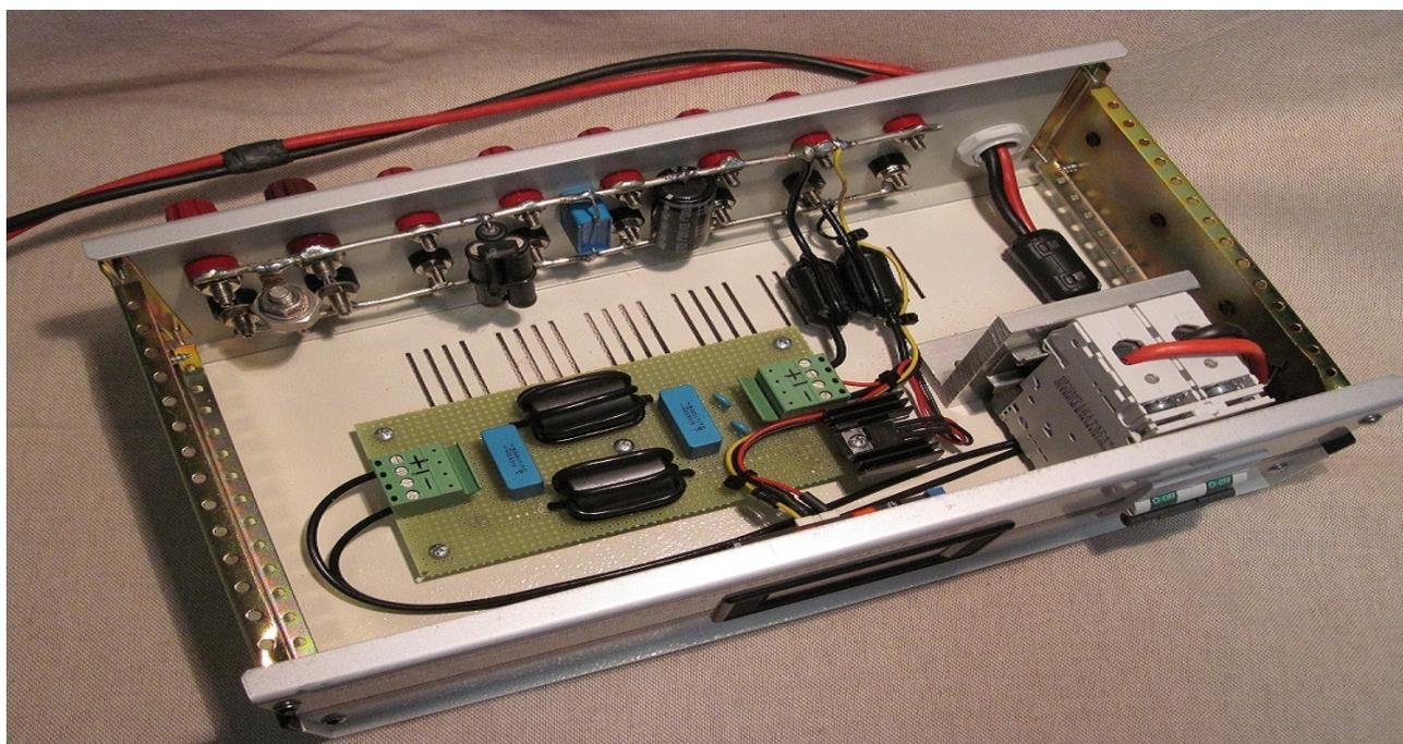
I cavetti di connessione degli apparati ed accessori meritano particolare attenzione nella preparazione, tenere ben presente la destinazione quindi gli assorbimenti ed in base a questo determinarne la sezione. Anche in questo caso non eccedere con le lunghezze (1.5 metri max), utilizzare spine a forcella per le apparecchiature con gli assorbimenti maggiori e a banana per gli accessori. Come per le boccole non lasciarsi illudere da chincaglierie di bassa qualità ma
