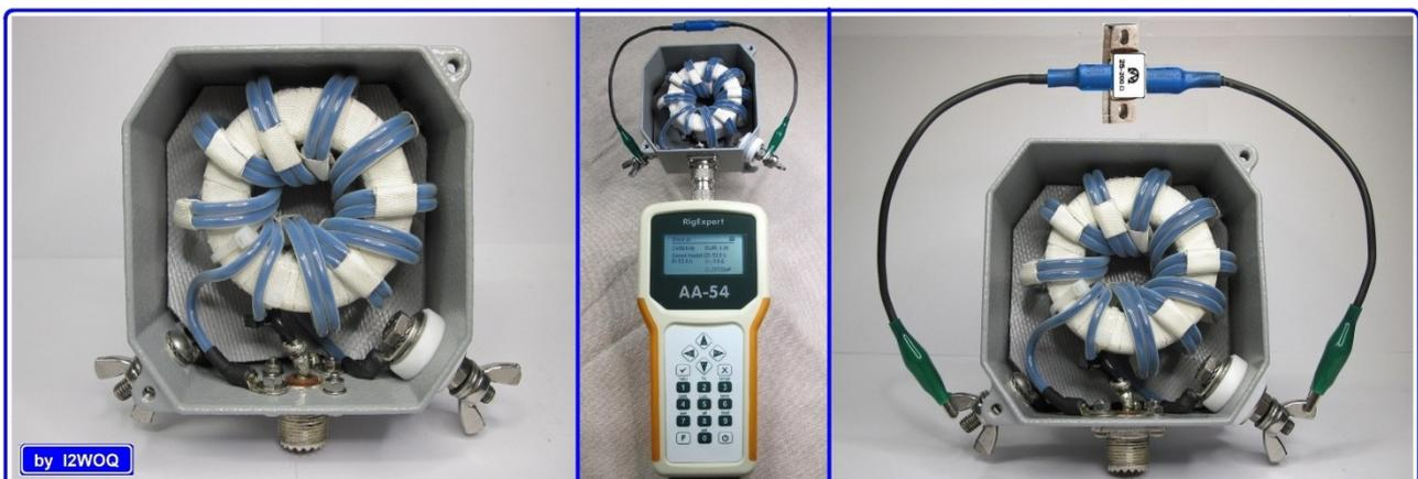
**ANALISI STRUMENTALE ESITI BALUN 4:1 CON CARICO ANTINDUTTIVO DA 200 Ohm**
