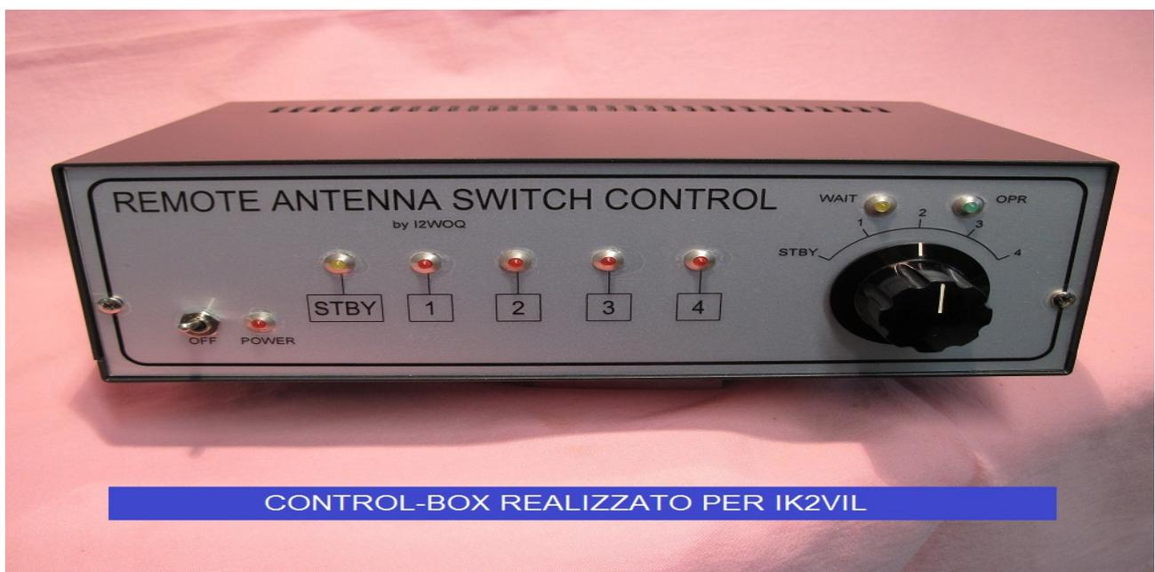
Per realizzare questo tipo di ControlBox è necessario assemblare un semplicissimo doppio alimentatore con uscite 26,5Vdc e 12Vdc sulla falsariga dello schema riprodotto:
