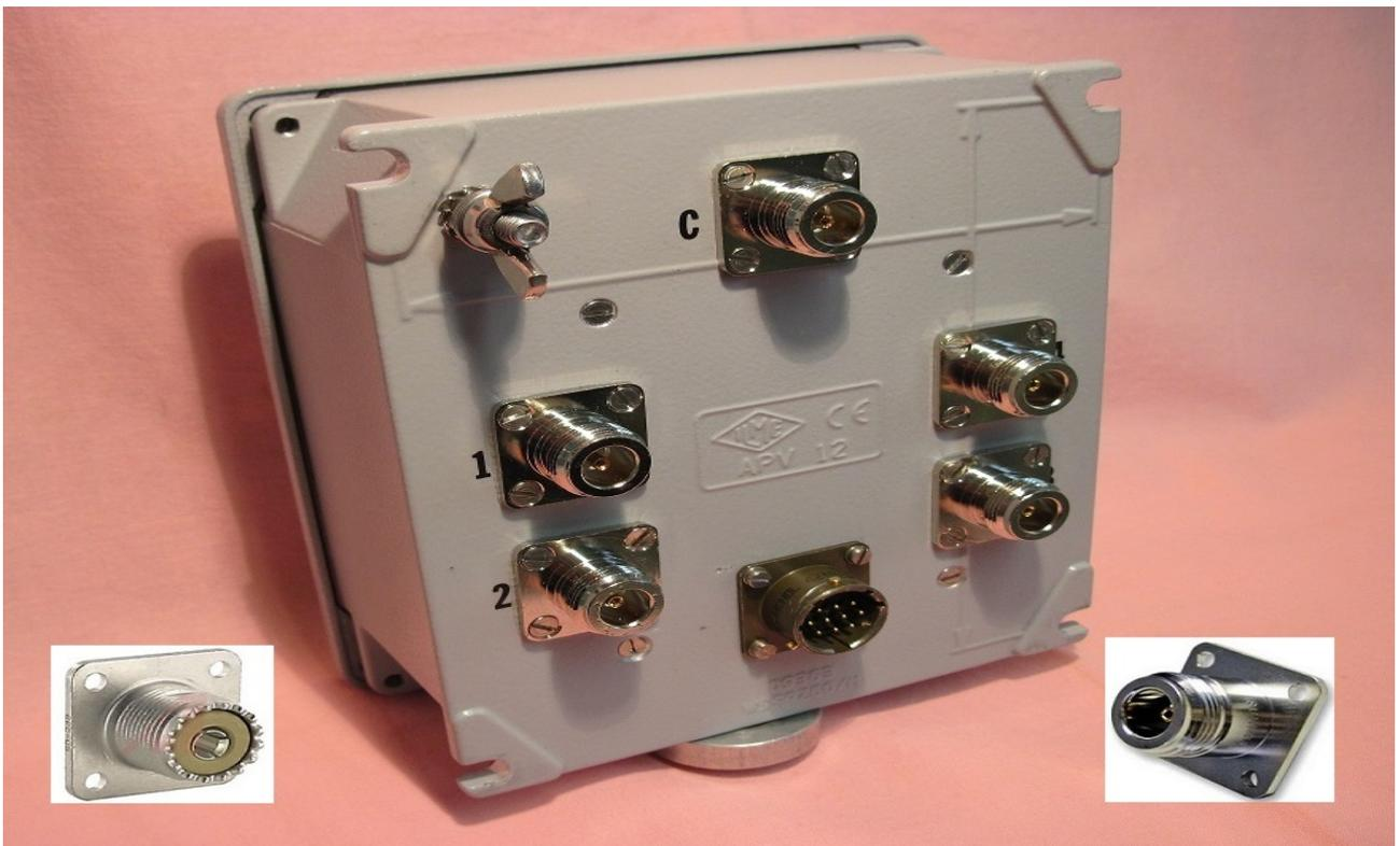
Per realizzare il Box Remoto relè ho utilizzato una cassetta in pressofusione a tenuta stagna IP66 (ILME APV 12). I connettori per la connessione delle antenne sono del tipo N femmina da pannello (Radiall), mentre il connettore per l'alimentazione relè è un Amphe-nol serie 62IN o similari ([esco@esco.it](mailto:esco@esco.it)). I relè sottovuoto utilizzati in questa realizzazione sono dei SIEMENS VR311 reperibili facilmente presso IK5HHA Luca ([ik5hha@gmail.com](mailto:ik5hha@gmail.com)).
