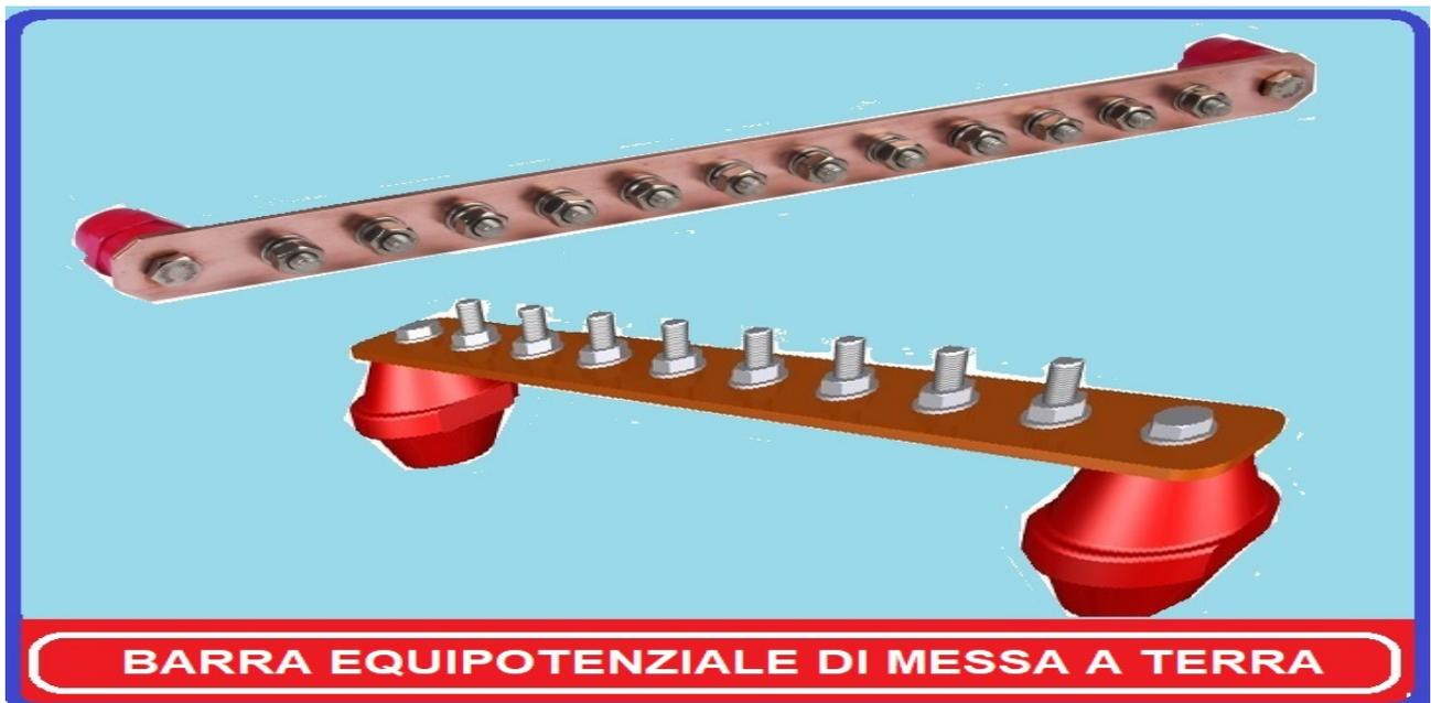
Per l'allacciamento tra le apparecchiature e la Barra Equipotenziale è consigliabile utilizzare la calza in rame sfilata da un comune cavo coassiale, saldando agli estremi dei capicorda ad occhiello in misura confacenti la connessione dei due punti.
