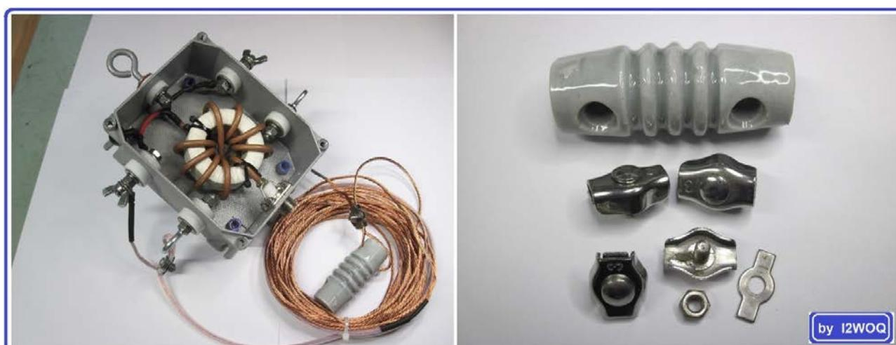
**PARTICOLARI UTILIZZATI NELLA COSTRUZIONE DEL BALUN**
