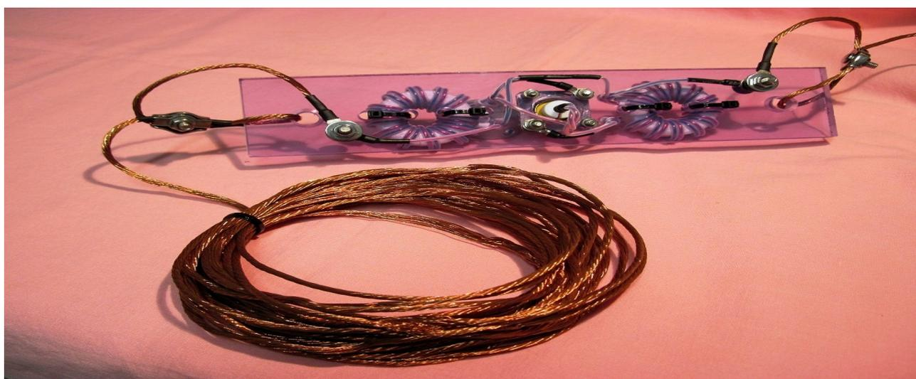
Il balun presentato in questo articolo fu realizzato impiegando toroidi FT140-77 e avvolgimenti con 11 spire, quindi ottimizzato per le frequenze basse della gamma HF (1.8-10 Mhz) ed è stato analizzato a banco con Antenna Analyzer Rigexpert AA-54, inserendo un carico anti-induttivo da 200 Ohm fra le due connessioni al posto dei cavi per l'antenna.
