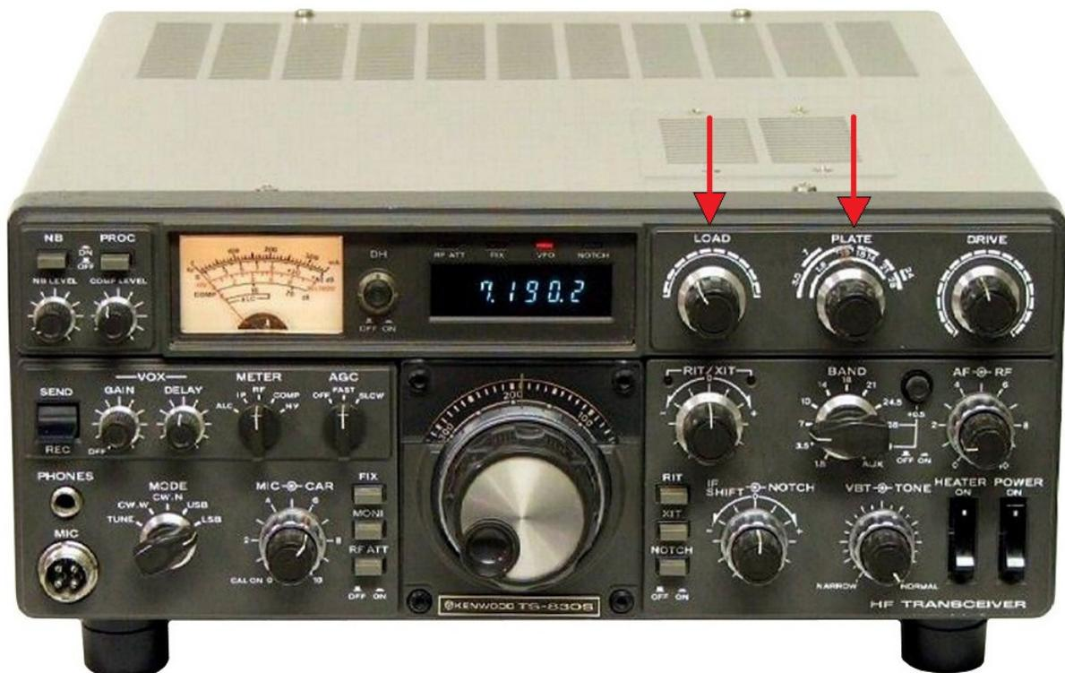
Il problema anni fa veniva aggirato abbastanza agevolmente perché i Ricetrasmittitori del tempo erano dotati di stadio finale a valvole con possibilità di controllo del LOAD e PLATE, in definitiva la facoltà di ottimizzare l'impedenza d'uscita in un campo più ampio, nor-
