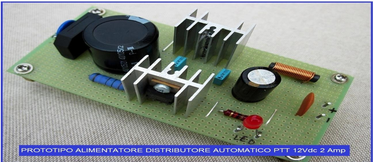
PROTOTIPO ALIMENTATORE DISTRIBUTORE AUTOMATICO PTT 12Vdc 2 Amp
