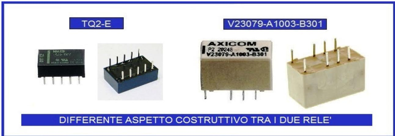
La sostituzione però si sarebbe presentata una operazione abbastanza delicata e non semplice da effettuare per due motivi: la diversa disposizione della piedinatura fra i due relè e la difficoltà della rimozione del TQ2-E causa le microscopiche piste a doppia faccia con fori metallizzati con cui era realizzato il circuito stampato RF INPUT BOARD, facilmente deteriorabili se non correttamente eseguita con competenza ed attrezzatura professionale adeguata.
