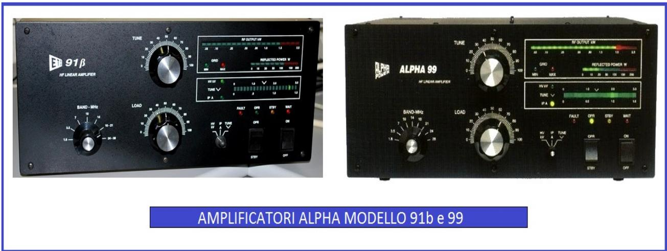
Da qualche tempo Pierangelo I2NOI segnalava anomalie di funzionamento del suo amplificatore ALPHA 91b, che sovente si rifiutava di commutare in trasmissione. Esaminato l'apparato minuziosamente rilevai anomalo funzionamento intermittente di un minuscolo micro relè (Nais TQ2-E 12Vdc) sul circuito RF INPUT BOARD.
