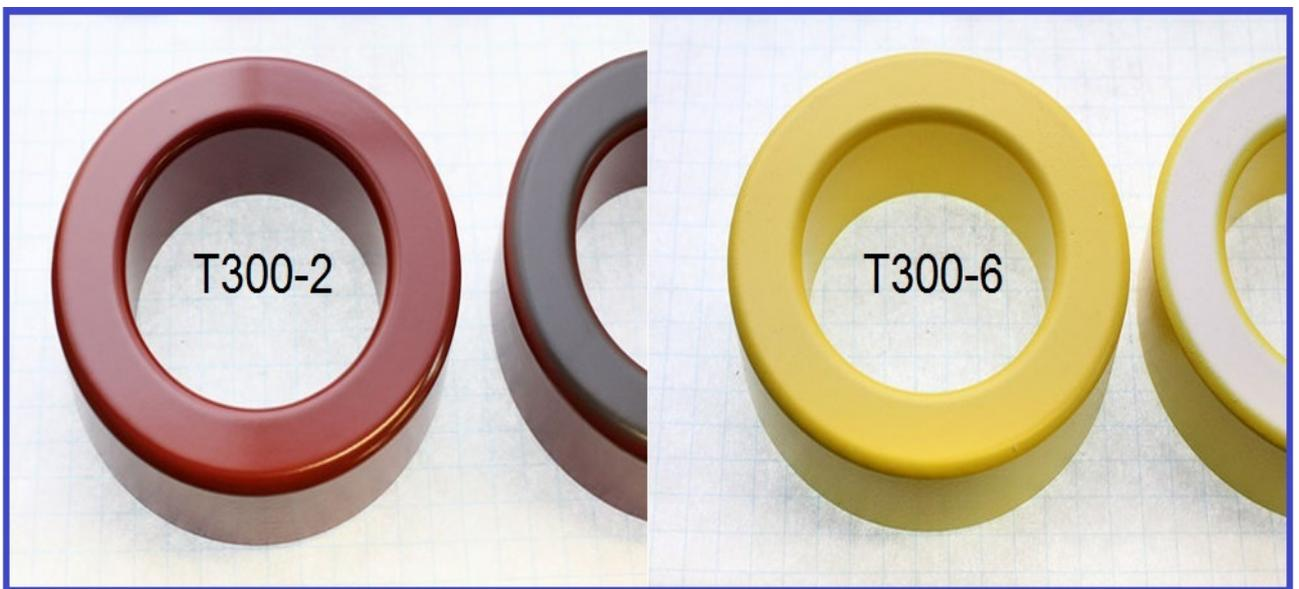
Per tenere compatti i cavi durante l'avvolgimento posizionare su di essi ogni 5cm circa del nastro in fibra di vetro 3M 27, avvolgere infine 13 spire bifilari in senso antiorario distribuendole sulla superficie dei toroidi spaziando uniformemente le spire e cercando di non accavallarle sul perimetro centrale. (Vedi esempio raffigurato)
